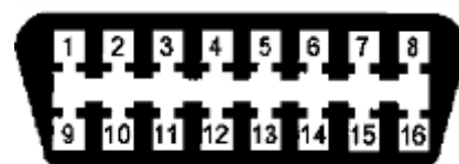
OBD-16F, вид со стороны пайки контактов
